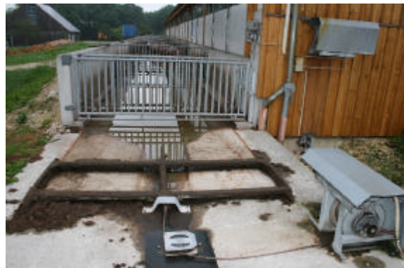
Betrieb 5: Auch Doppel-Klappschieber verlangen für den Betrieb ebene Entmistungsf lächen
