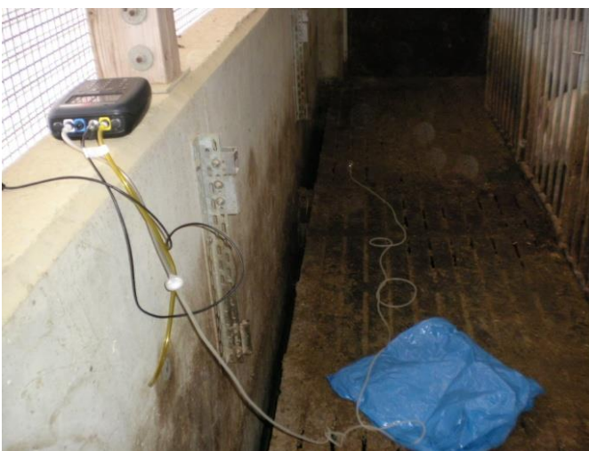
Bild links: Messposition des Messgerätes „Biogas 5000“. Die Ansaugkugel des Messgerätes liegt auf Spalteniveau über dem Rührwerk
