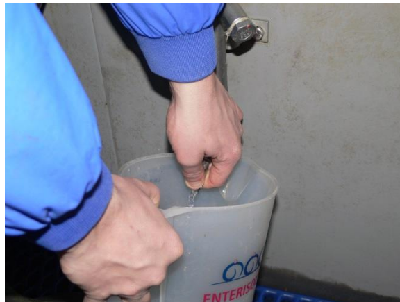
Abbildung 2: Auslitern einer Tränke – Überprüfung der Durchflussrate der Tränke
