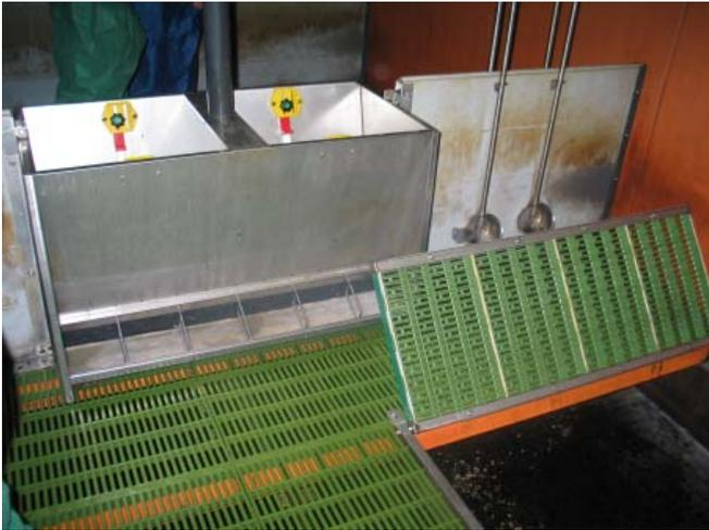
Abbildung 7: Luke im Flatdeck für Reinigungsarbeiten im Güllebereich
