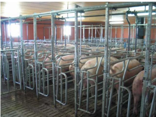
Abbildung 5: Fress- Liegestände mit zentral steuerbaren Pendeltüren
