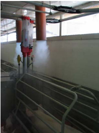
Abbildung 1: Rauchprobe bei der Nasenlüftung von oben
